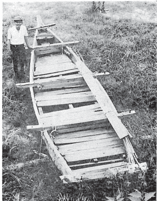
写真 (14) 島根町野波のサンパ船。全長6.4m、最大幅1.5m、高さ50cm(昭和60年6月20日。標準レンズ)
