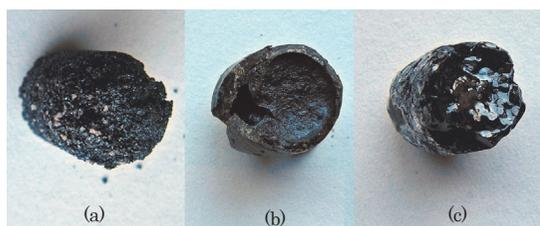
図2. 砂鉄の溶融状態
