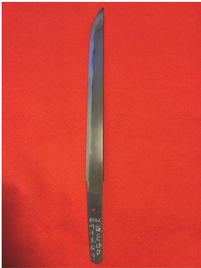
図4. 鍛造した短刀
